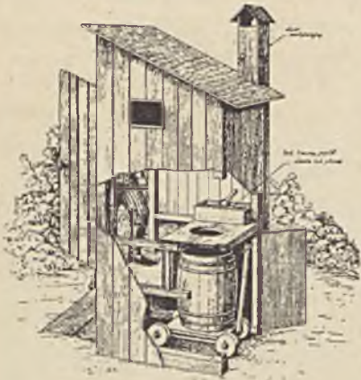
Rys. 101. Ustęp systemu beczkowego (podług inż. Rudolfa).
