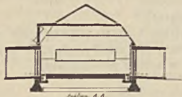
Rys. 59 i 60. Oświetlenie izb szkolnych oknami z dwóch stron. a) widok, b) przekrój.
