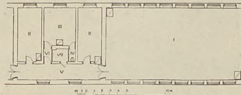
Rys. 128. Rozplanowanie sali gimnastycznej i pomieszczeń pomocniczych: I — sala gimn. o wymiarach 17 \times 9 m, II — dwie szatnie, III — natryski, IV — ustep, V — korytarzyk, łączący salę z innymi pomieszczeniami szkolnymi, VI — korytarzyk, prowadzący do natrysków, VII — pomieszczenie na kociołek. Projekt nie uwzględnia składu na przyrządy gimnastyczne i pokoju dla nauczyciela.
