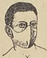
Rys. 327. Prosty respirator dla zatrzymywania pyłu.
