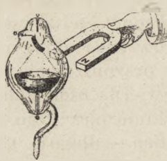
Odchylenie promieni katodalnych przez magnes.
