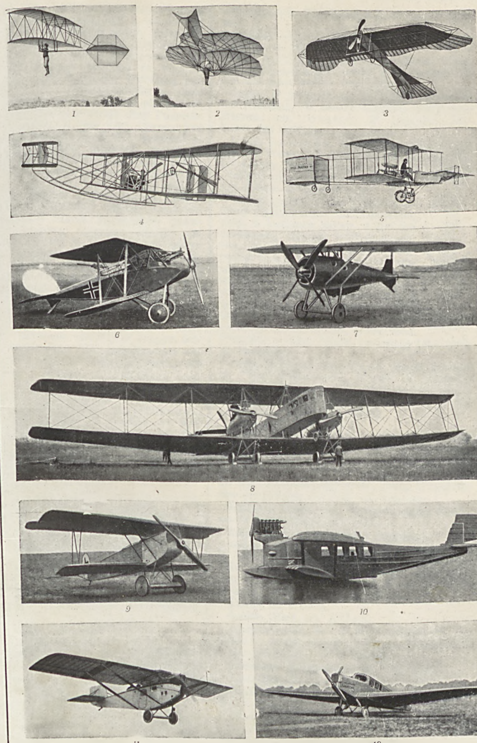
1. Szybowiec Herring'a (ameryk. 1897). 2. Szybowiec Lilienthal'a (1896). 3. Jednopłatowiec Etrich'a „Gołąb“ 1910). 4. Dwupłatowiec br. Wright (ameryk. 1908). 5. Dwupłatowiec Farmana (franc. 1907). 6. Aeroplan wojskowy typu Halberstadt CL. 4 (1917). 7. Aeroplan jednoosobowy Siemens D8 (1918). 8. Aeroplan-olbrzym Staaken (1917). 9. Aeroplan jednoosobowy Fokker D7 (1916). 10. Hydroplan Dornier-Delphin (1921). 11. Jednopłatowiec komunikacyjny z kabinami (1921). 12. Aeroplan Junker'a (1919).
