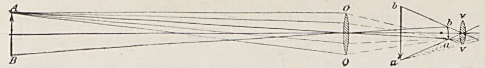
1. Luneta astronomiczna: bieg promieni; AB przedmiot oddalony, którego rzeczywisty, zmniejszony i odwrócony obraz (ba), wywołany przez obiektyw (oo), oglądany jest przez okular (re); okular daje prosty, powiększony i urojony obraz (b'a) obrazu (ba).
