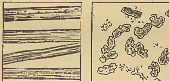
Rys. 111 i 112 Nitki jedwabiu sztucznego oglądane przez mikroskop. (150-krotne powiększenie). Na rys. 112 obraz poprzecznego przekroju nitki.
